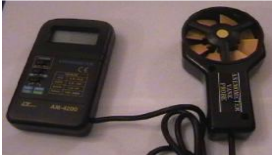
شکل 5: بادسنج پروانه‌ای دیجیتالی پره
